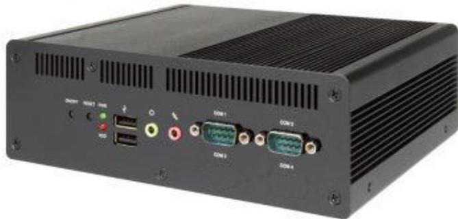
**СПАРКС JW632** - Малогабаритные промышленный ПК СПАРКС с пассивным охлаждением может использоваться для встраиваемых компьютерных комплексов (банкоматы, платежные терминалы и т.п.), а также для мобильных бортовых систем. Решения СПАРКС являются высоко производительными компьютерами с пониженным энергопотреблением, а также предусмотрены различные возможности монтажа корпуса устройства. Для каждой модели предлагается несколько базовых конфигураций.
